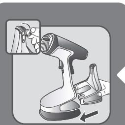
**BG** Върнете резервоара за вода на мястото му в уреда. Уверете се, че резервоарът за вода е поставен добре на мястото си и е заключен.
