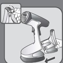
**BG** Върнете резервоара за вода на мястото му в уреда. Уверете се, че резервоарът за вода е поставен добре на мястото си.
