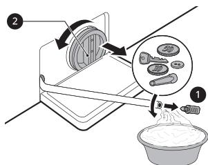
**4** Nakon čišćenja filtera odvodne pumpe, pažljivo ponovo umetnite filter i zavrnete čep na odvodnu cev u pravcu kazaljki na satu da izbegnete preplitanje niti i curenje. Ponovo umetnite čep na odvodnu cev i postavite cev u držač.
