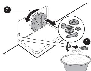
**4** A leeresztő szivattyú szűrőjének tisztítása után óvatosan helyezze vissza a szűrőt, és óvatosan csavarja vissza a lefolyókupakot az óramutató járásával megegyező irányban, hogy biztosítsa a menet illeszkedését és elkerülje a szívárgást. Helyezze vissza a dugót a lefolyócsőbe, és helyezze a csövet a tartójába.
