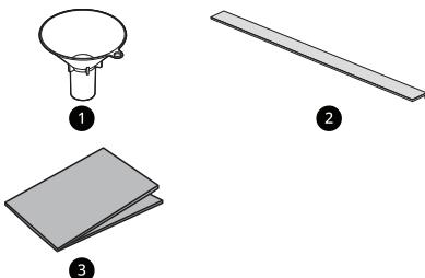
**① Lijevak****② Traka protiv buke<sup>\*1</sup>****③ Traka za sprečavanje vlage (aluminijumska traka)**
