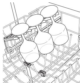
Lijevi red zubaca može se preklopiti prema dolje ili se stalci za šalice mogu preklopiti da bi se napravilo mjesto za visoko zemljano posuđe.
