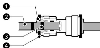
1 Čahura za zatezanje 2 Cijev 3 Oznaka za umetanje 4 Spojnica
