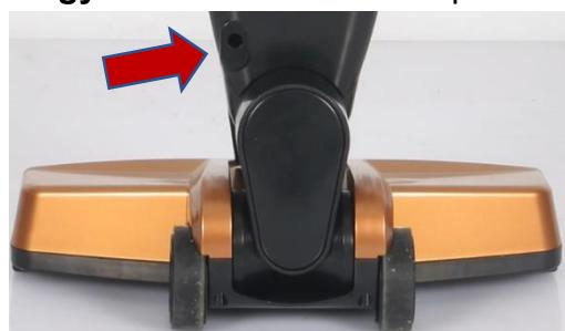
A készülék feltöltése 4.5 órát vesz igénybe. Az akkumulátoron lévő LED jelzés mutatja a töltöttségs állapotát. A tényleges töltési idő az akkumulátor töltöttségi állapotától függ. Ne hagyja teljesen lemerülni az akkumulátort!
