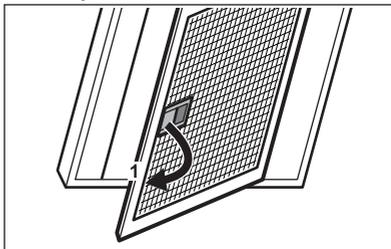
3. Reinig de vetfilters met de hand met een spons met niet-schurende reinigingsmiddelen of reinig ze in een vaatwasser. We raden aan om de vetfilters met de hand te reinigen.
