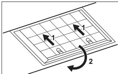
3. Kallutage filtri esiosa kergelt allapoole, seejärel tõmmake.
