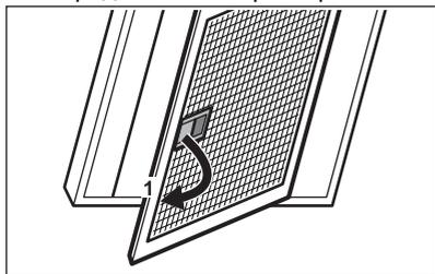
3. Очистите жирулавливающие фильтры вручную с помощью губки с добавлением неабразивного средства для очистки или вымойте их в посудомоечной машине. Очистку жирулавливающих фильтров рекомендуется выполнять вручную.
