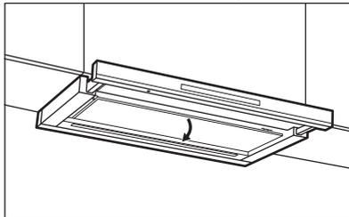
2. Tirez sur le levier du filtre sous la hotte et basculez légèrement l'avant du filtre vers le bas.
