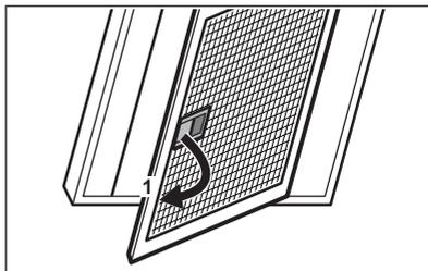
3. Rengør fedtfilterene i hånden med en svamp med ikke-slibende rengøringsmidler, eller rengør dem i en opvaskemaskine. Vi anbefaler at rengøre fedtfilterene med hånden.
