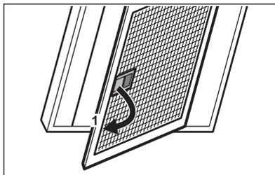
3. Nettoyez les filtres à graisse à la main à l'aide d'une éponge avec des détergents non abrasifs ou nettoyez-les au lave-vaisselle. Nous recommandons de nettoyer les filtres à graisse à la main.
