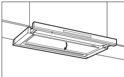
2. Потяните ручку фильтра под вытяжкой и немного наклоните вниз переднюю часть фильтра.
