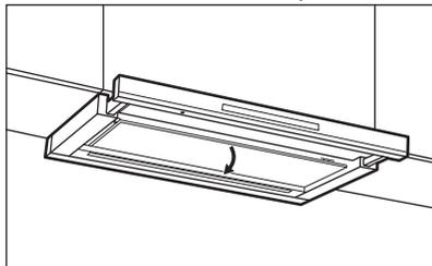
2. Dra i håndtaket på filteret under ventilatoren og bøy fronten på filteret forsiktig ned.
