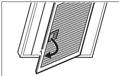
3. Tukové filtry čistěte ručně pomocí houbičky s neabrazivními čistícími prostředky nebo použijte myčku nádobí. Tukové filtry doporučujeme čistit ručně.
