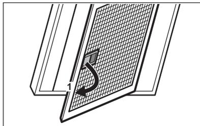
3. Curățați filtrele de grăsime manual, cu un burete cu detergent neabraziv, sau în mașina de spălat vase. Vă recomandăm să curățați filtrele de grăsime manual.
