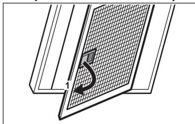
3. Tisztítsa meg a zsírszűrőket kézzel és egy szivacs segítségével és nem súroló tisztítószerrel, vagy használjon mosogatógépet. Javasoljuk a zsírszűrők kézi tisztítását.
