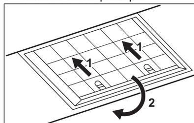
3. Немного наклоните переднюю часть фильтра вниз, а затем потяните.
