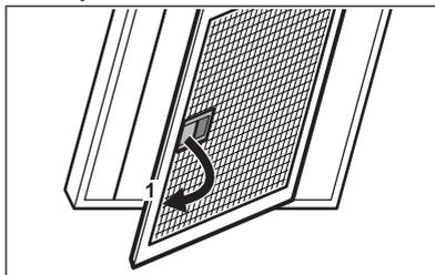
3. Filtar za masnoću očistite ručno koristeći spužvu s neabrazivnim deterdžentima ili ga očistite u perilici posuđa. Preporučujemo ručno čišćenje filtera za masnoću.
