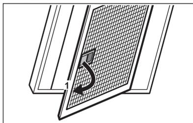
3. Tukové filtre čistite ručne pomocou špongie s neabrazívnymi čistiacimi prostriedkami alebo ich čistíte v umývačke. Odporúčame ručné čistenie tukových filtrov.
