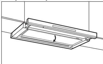
2. Zatáhněte za držadlo na filtru pod odsavačem par a přední část filtru naklopte mírně dolů.
