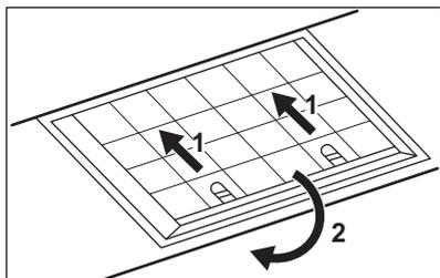
3. Inclíne ligeramente la parte delantera del filtro hacia abajo y tire.
