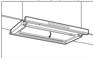
2. Потягніть ручку на фільтрі під витяжкою і злегка нахиліть передню частину фільтра вниз.
