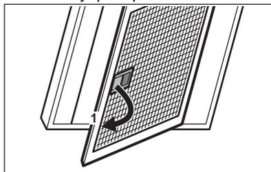
3. Очистіть жирові фільтри вручну за допомогою губки з використанням неабразивних мийних засобів або вимийте їх у посудомийній машині. Ми рекомендуємо очищувати жирові фільтри вручну.
