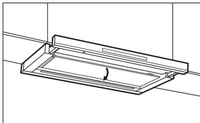
2. Τραβήξτε τη λαβή στο φίλτρο κάτω από τον απορροφητήρα και γείρετε ελαφρώς προς τα κάτω το μπροστινό μέρος του φίλτρου.
