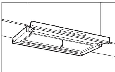
2. Tire de la empuñadura del filtro por debajo de la campana e incline ligeramente la parte delantera del filtro hacia abajo.
