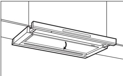
2. Tõmmake õhupuhasti all asuvat kinnitusklabri hoidikut ja kallutage filtri esiosa kergelt allapoole.
