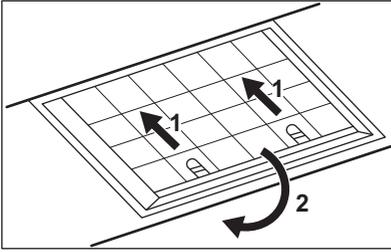
3. Kallista suodattimen etuosaa hiukan alaspäin ja vedä sen jälkeen.
