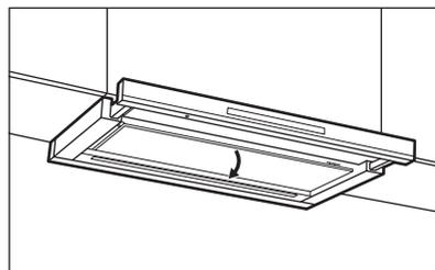
2. Puxar a pega do filtro, na parte inferior do exaustor, e inclinar ligeiramente para baixo a parte da frente do filtro.
