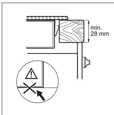
2. Priložen tesnilni trak 2x6 mm nalepite na spodnji rob kuhalne plošče vzdolž zunanjega roba steklokeramične plošče. Ne raztegnite traku. Poskrbite, da bosta konca tesnilnega traku na sredini ene od stranic kuhalne plošče.
