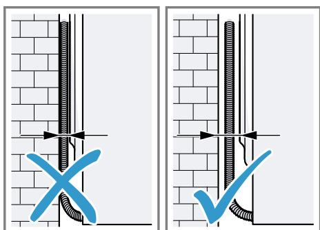
Pazite da crijeva i mrežni priključni vod nisu priklješteni između zida i uređaja.
