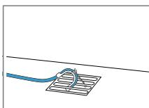
Gurnite odvodno crijevo za vodu skroz kroz koljeno i fiksirajte materijalom za pričvršćivanje.
