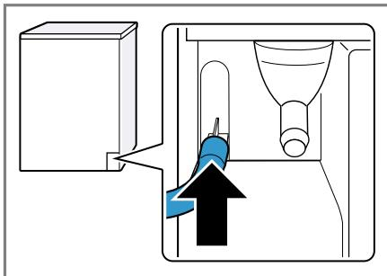
3. Odvodno crijevo za vodu nataknite na nastavak do graničnika.
