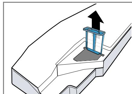
3. Očistite filter pod tekućom, toplovodnom vodom.
