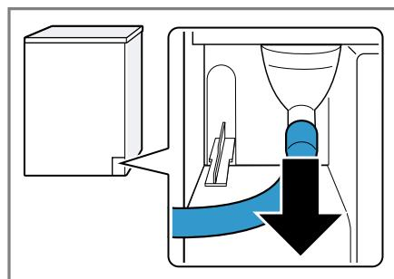
Crijevo za odvod kondenzata je tvornički priključen na nastavak.
