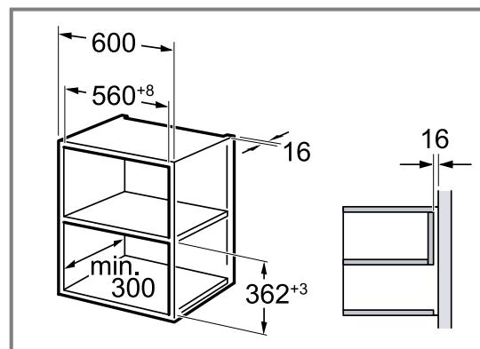
Прилад можна будовувати лише на тій висоті, на якій можна легко виймати з нього приладдя. Зніміть ніжки.
