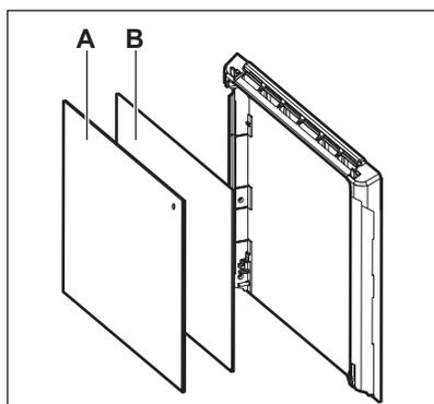
Veenduge, et keskmised klaaspaneelid on paigaldatud oma kohale õigesti.
